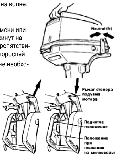
Рычаг стопора подъема мотора
