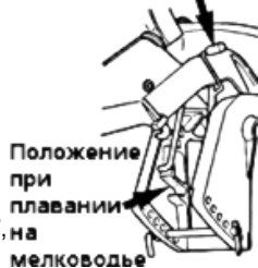
Рычаг стопора подъема мотора
