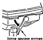
Запор крышки мотора
